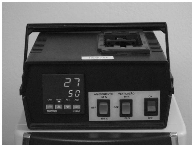
Figura B.2 - Fotografia frontal do processo térmico, mostrando controlador PID comercial e chaves de comando
