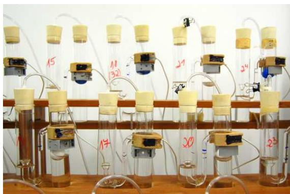
Figura 5.2: Coletores usados para medição da vazão de biogás.
