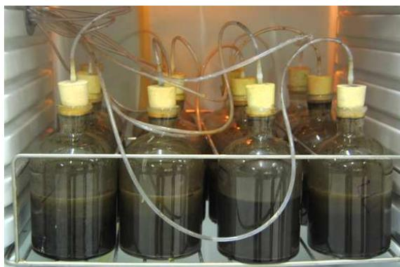
Figura 5.1: Biorreatores de bancada com 1 litro.
